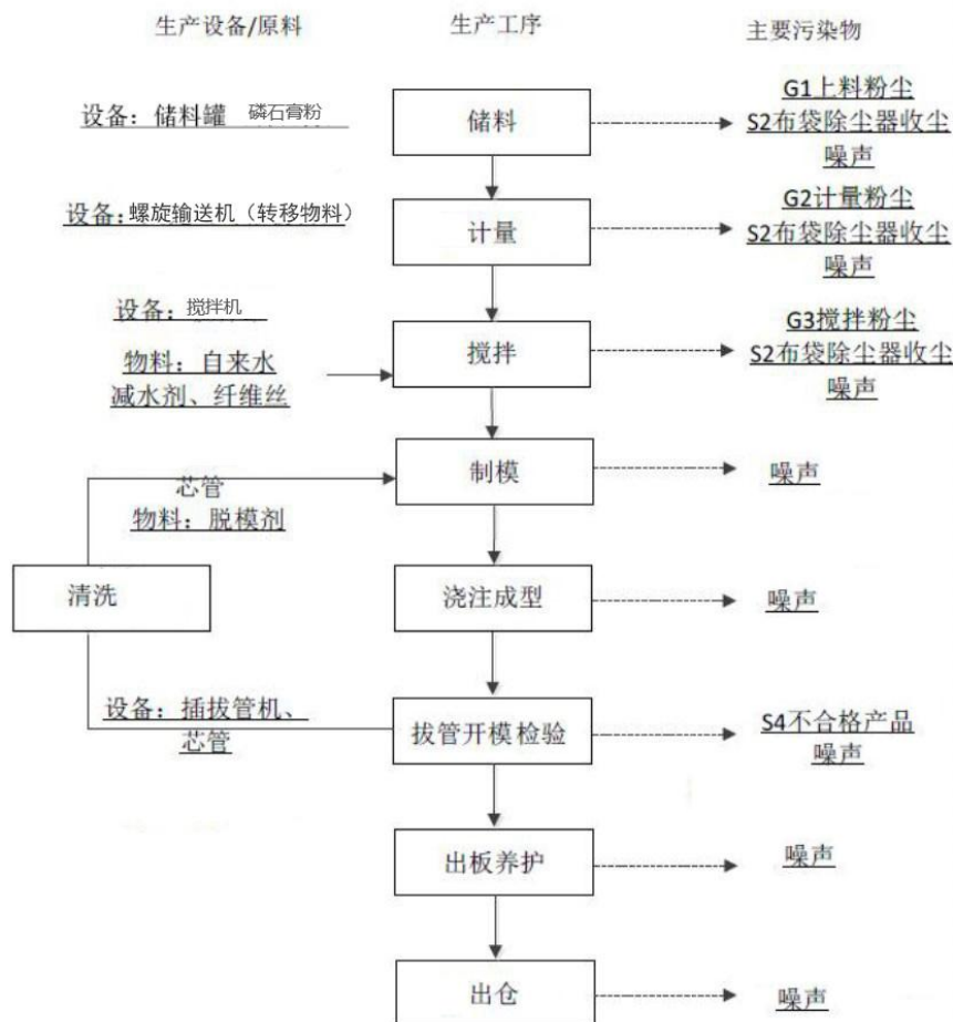
图 5-2 运营期预制构件工艺流程及产污位置图
